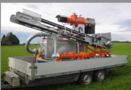
Die mobile Separationseinheit wird mittels Grundrahmen fest mit dem offenen PKW-Anhänger verschraubt.
