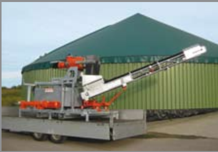
Rüstzeit ca. 5 min bis zur Inbetriebnahme der mobilen Separationseinheit.
