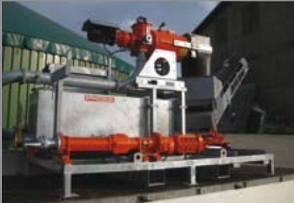
Förderband manuell 180° seitlich schwenkbar. Stufenlose hydraulische Höhenverstellung.
