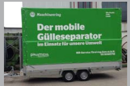
Geschlossener Anhänger mit Rollfixsystem der Anhängerplane für einfache Handhabung im Praxiseinsatz.
